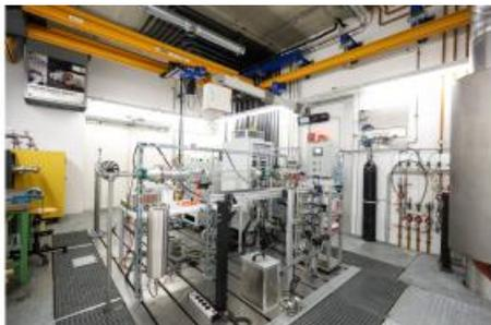
Stack-Prüfstand für Brennstoffzellen und Elektrolyseure am Institut für Thermodynamik und nachhaltige Antriebssysteme der TU Graz
