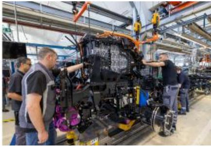
Das E-Powerpack wird in einer eigenen Vormontagelinie in Bandnähe aufgebaut. Es besteht unter anderem aus zwei Batterieeinheiten, dem HV-Verteiler und dem Klimakompressor
