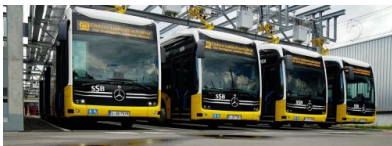
Quelle: Die Busladestation mit Pantografen in Stuttgart Quelle: Daimler Buses
