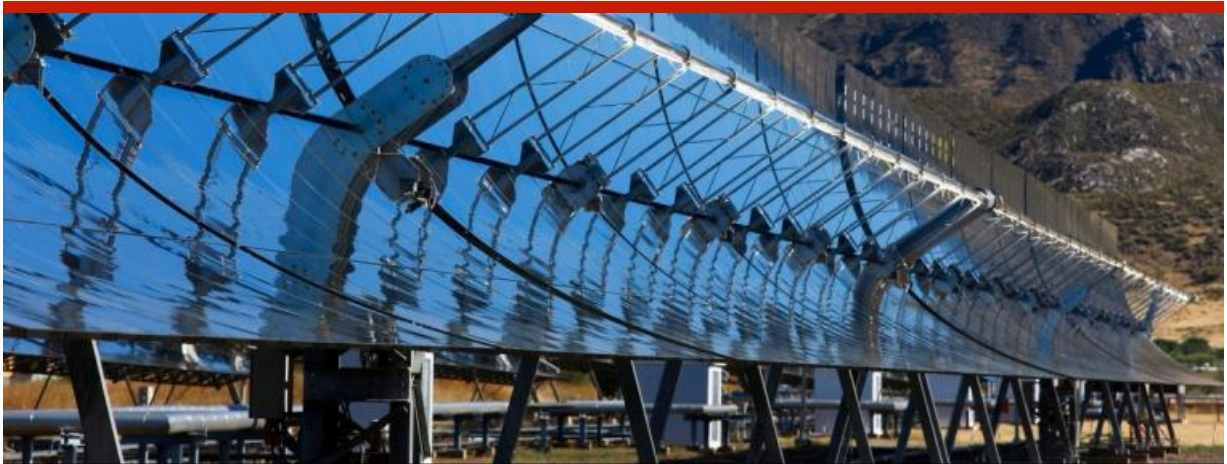
Beispiel einer Parabolrinne. Quelle: DLR
