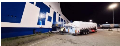
Probetankung der TT-Line-Fähre Peter Pan mit Bio-LNG in Travemünde. Quelle: Schenk Tanktransport GmbH / Jan-Peter de Haan
