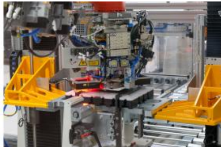
Die Stacking-Anlage der „Referenzfabrik.H2“: Hubeinheit für Brennstoffzellenstapel (orange), Werkstückträger mit Führungen (Mitte), Transfersystem, Greifer mit Fließsauger, Abstreifer und zwei Kameras zur Lagekorrektur Quelle: Fraunhofer IWU
