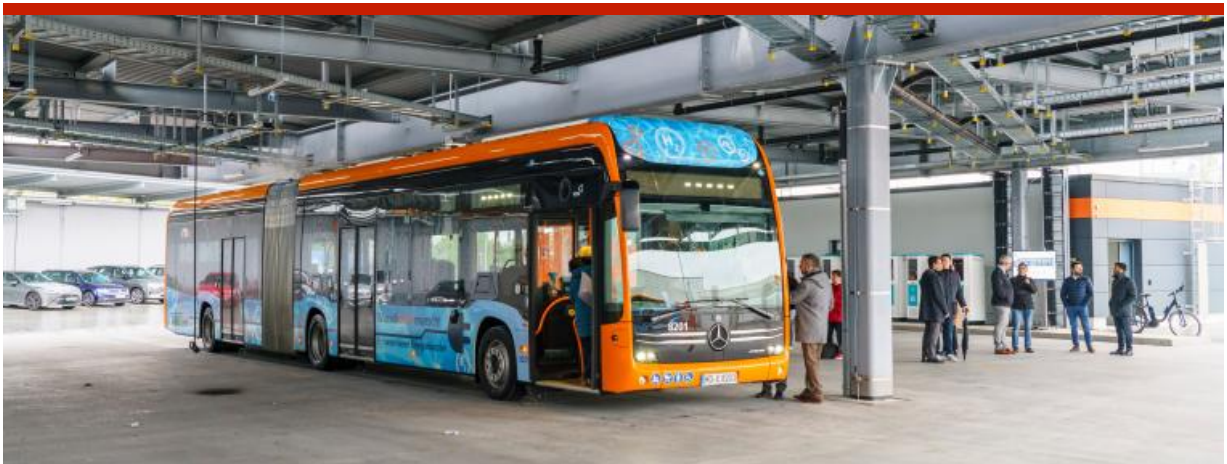
E-Citaro mit Brennstoffzelle als Reichweitenverlängerer. Quelle: RNV
