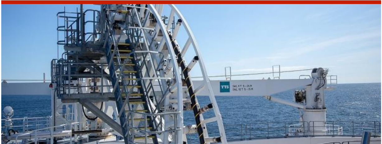
Abspulen des Seekabels auf einem Verlegeschiffs. Quelle: Tennet
