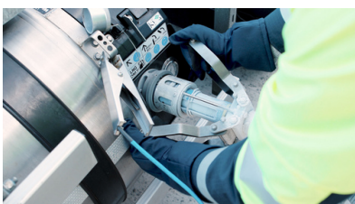
LNG-Tanken beim LKW. Quelle: Liqvis
