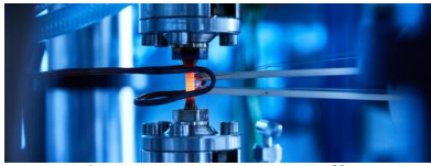
Untersuchung einer mit Wasserstoff beladenen Hohlprobe aus einem Turbinenwerkstoff. Quelle: Kai Wudtke / Fraunhofer IWM
