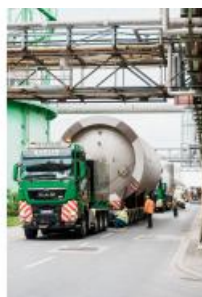
Per Schwertransport ging es für den Plattenfallfilmverdampfer über das BASF-Werksgelände in Ludwigshafen Quelle: BASF
