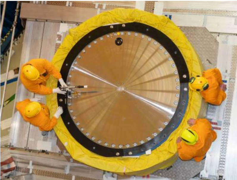
Der Sekundärdeckel des letzten Castors wird verschraubt.
