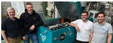
Das Wasserstoff-BHKW am Prüfstand der Hochschule. Quelle: Hochschule Reutlingen
