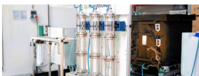
Pilotanlage des Fraunhofer IEG zur Adsorption von Lithium aus Thermalwasser. Quelle: Neptune Energy
