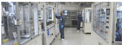
Halbautomatische Fertigungslinie für industriennahe Pouch-Zellen im Trockenraum des Fraunhofer ISE im Zentrum für Elektrische Energiespeicher. Quelle: Fraunhofer ISE
